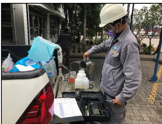
รูปที่ 3.2 การเก็บตัวอย่างคุณภาพน้ำทิ้ง บริเวณบ่อดักน้ำทิ้งที่ผ่านการบำบัดแล้วก่อนปล่อยลงสู่ทะเล (ตึก Admin)
